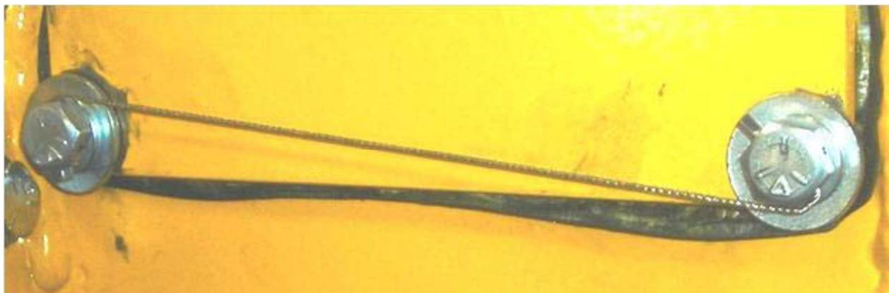
Arame de freio pré-fabricado instalado<sup>3</sup>
